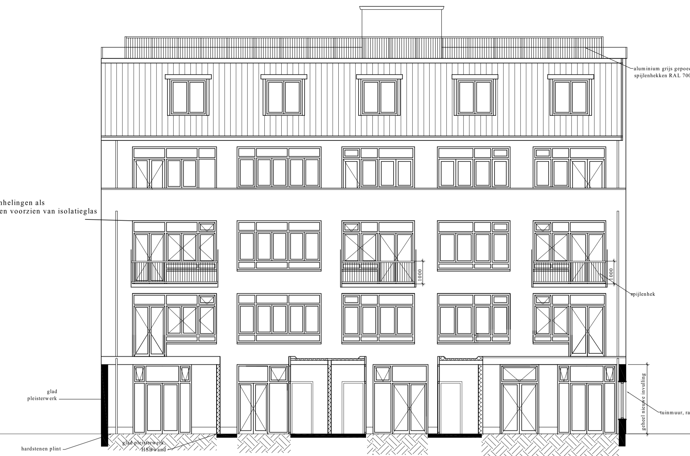
ACHTERGEVEL nieuwe kozijnen en aanhelingen als bestaand gedetailleerd en voorzien van isolatieglas zie voor constructie gegevens constructeur
