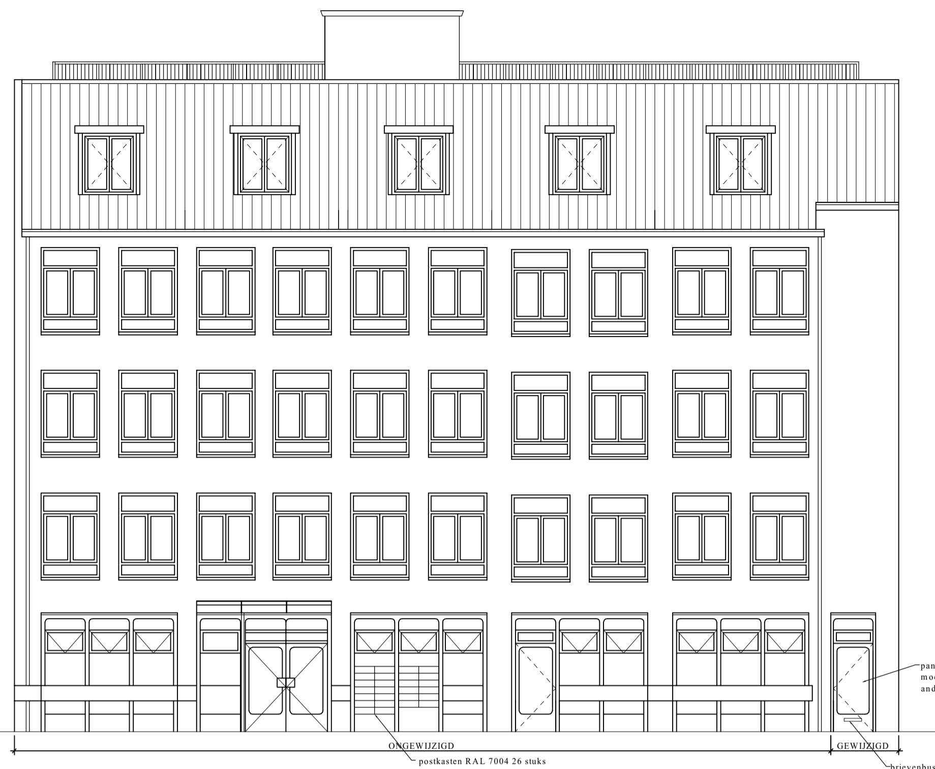
VOORGEVEL schilderen en reinigen, kozijnen, ramen en deuren RAL 9010/7004
